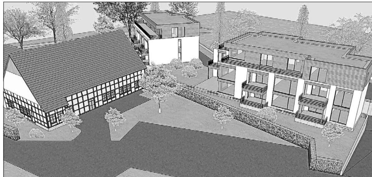
Holzabdeckungen an den oberen Geschossen der neuen Häuser greifen das Fachwerk auf und der weißen Putz schafft eine optische Verbindung zum Bauernhaus. Zeichnung: Architekten Bökamp
